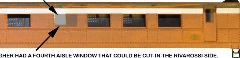
THE ORIGINAL HAD A FOURTH AISLE WINDOW THAT COULD BE CUT IN THE RIVAROSSI SIDE. I CUT A SHORT BLANK PANEL BETWEEN THE DINING AND AISLE WINDOWS, AND I LEFT THE THREE ORIGINAL AISLE WINDOWS.
